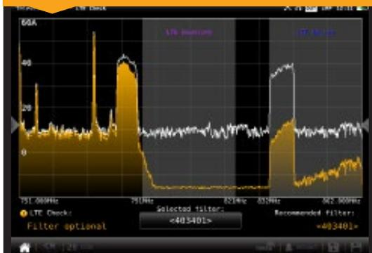
Zur Analyse von Auswirkungen des LTE-Signals auf die DVB-T/T2-Kanäle und Erkennung ob der Einsatz von Filtern erforderlich ist. Darüber hinaus ermöglicht die Funktion die Spektrumsimulation bei der Implementierung eines vom Messgerät empfohlenen LTE-Filters. Es wird eine Liste von Filtern angezeigt, aus der der Benutzer denjenigen auswählen kann, der seinen Anforderungen am besten entspricht.
