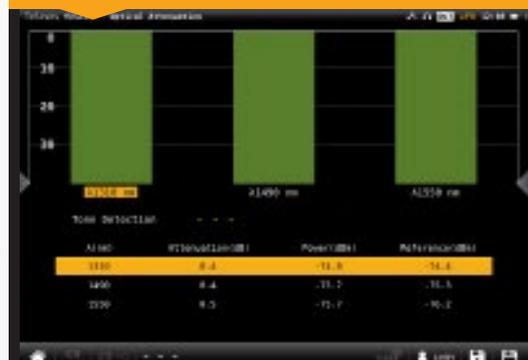
Sobald der Glasfasereingang aktiviert wurde kann dank des optischen Empfängers (selektiv oder nicht) die Messung der optischen Dämpfung für drei Wellenlängen (1310 nm, 1490 nm und 1550 nm) und deren Leistungen durchgeführt werden.
