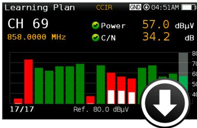
Das Messgerät erkennt automatisch, ob es eine neue Softwareversion gibt, wenn es mit dem Internet verbunden ist (WLAN, Ethernet). Um die Verfügbarkeit neuer Software zu signalisieren, wird in der rechten oberen Ecke ein Symbol aktiviert, ohne dass der Benutzer die Arbeit unterbrechen muss. Das Geräte-Update erfolgt über das Konfigurationsmenü.
