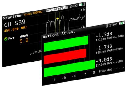
Dieses Gerät ist mit einem optischen Empfänger ausgestattet (selektive oder nicht-selektive Ausführung), der die Messung von Leistung und Dämpfung bei Wellenlängen von 1310nm, 1490nm und 1550nm ermöglicht. Die Kombination der selektiven Option mit dem Dreifach-Lichtgenerator (OPS3L) ermöglicht eine professionelle Einmessung von Informations- und Telekommunikationsnetzwerken.
