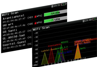
Diese Funktionalität ermöglicht eine vollständige Analyse des Wi-Fi-Bandes zur automatischen Erkennung aller Netzwerke. Alle werden jeweils durch den Namen identifiziert, und die Stärke des Signals am Zugangspunkt wird ebenfalls angezeigt. Es stehen zwei Anzeigemodi zur Auswahl. Der Modus "Liste" stellt eine Liste der erkannten Netzwerke mit den zugehörigen Daten und Leistungen zur Verfügung, während der Modus "Karte" diese auf einer zweiachsigen Karte darstellt: Leistung vs. Frequenz.
