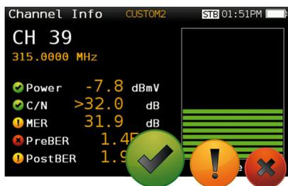
Installationsfehler einfach und unkompliziert mit der Ampeldarstellung erkennen. Hierbei handelt es sich um eine grafische Darstellung, die die Interpretation der Messergebnisse vereinfacht und optimiert. Es stehen, je nach Netz das analysiert werden soll, verschiedene Qualitätsprofile zur Verfügung: LNB, Übergabepunkt, Kopfstelle, Teilnehmerdose, etc. Zu den voreingestellten Werten können persönliche Werte eingegeben werden.
