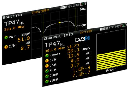
Diese Funktionalität für DVB-S/S2 ermöglicht die vollständige Analyse eines Satellitenkanals auf jeder Frequenz im Bereich von 250 MHz bis 2300 MHz. Somit kann das Messgerät direkt an den Ausgang eines Wideband-LNBs angeschlossen werden (2 Ausgänge: Vertikal und Horizontal).
