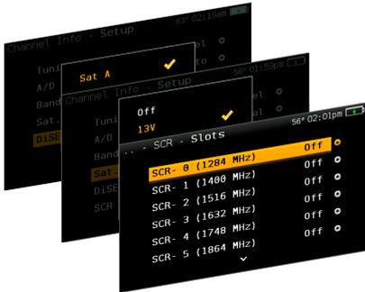
Mit dem H30Crystal können alle wichtigen Parameter gemessen und eingestellt werden, die für den Empfang eines Satellitensignals nötig sind. Mit der SCR-Funktion (Option 593534) können auch moderne Einkabelanlagen mit dCSS-Technologie eingemessen werden.
