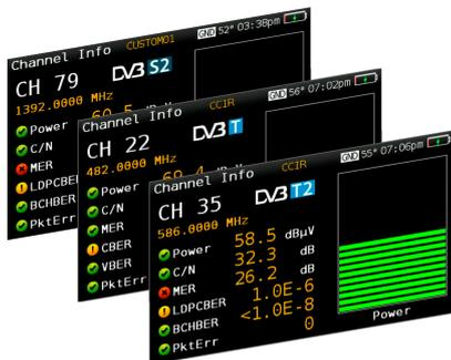
Das H30Crystal erfüllt die besonderen Anforderungen der Antennenmesstechnik für ein zukunftsfähiges TV-Verteilnetz. Es ist ein Multi-Standard-Messgerät, das Satelliten-Messungen durchführen kann, aber auch, je nach Konfiguration Terrestrische-Signale messen kann. Da sich Bedürfnisse und Anforderungen an ein Messgerät zukünftig ändern können, bietet das H30Crystal jederzeit die Möglichkeit zusätzliche Optionen hinzuzufügen, ohne dass das Messgerät eingeschickt werden muss.
