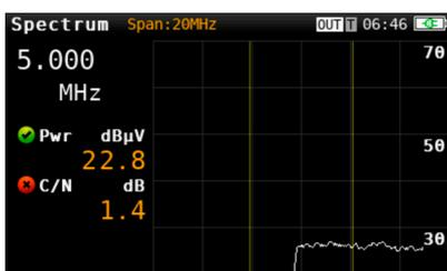
Die Möglichkeit den Rückkanal ab 5 MHz zu messen, ist für Kabelinstallationstechniker sehr nützlich. Durch die Anzeige des Signals im Spektrum, die Messung von Leistung und C/N ist es möglich, einen guten Status und eine gute Qualität der auf dieser Bandbreite übertragenen Upload-Daten sicherzustellen.
