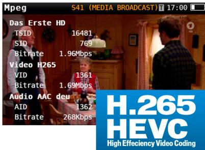
Mit dieser Funktionalität wird das neue Kompressionsformat HEVC H.265 unterstützt und ermöglicht die Anzeige von Videosignalen mit einer maximalen Full HD-Auflösung (1920 x 1080). Die Informationen können sowohl auf dem Bildschirm des Messgeräts als auch auf dem mobilen Gerät (Multiscreen-Modus) angezeigt werden, sofern Ihre Hardware H.265-kompatibel ist (normalerweise ein Smartphone, Tablet oder PC der neuesten Generation).
