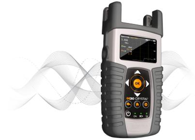
Das H30Crystal wurde von Anfang an dafür entwickelt alle Signale sofort in Echtzeit zu empfangen und darzustellen. Das Gerät bietet die Präzision und Schnelligkeit, die für die gezielte Fehlersuche in DVB-S/ S2/C/T/T2-Anlagen nötig sind.
