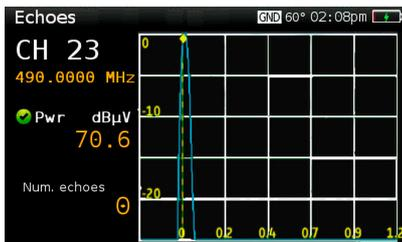
Bei der Erfassung von terrestrische Signalen ist es von größter Wichtigkeit, darauf zu achten, dass es keine Echos gibt, die Probleme beim Empfang der Signale verursachen können. Das H30Crystal ermöglicht die Visualisierung der Echos des empfangenen Signals, was es dem Installateur erlaubt, diese Echos bestmöglich zu minimieren, um einen optimalen Signalempfang zu erreichen.
